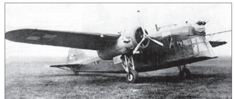
„Żubr” po wymianie silników na mocniejsze. Śmigła trójłopatkowe (źródło: www.airwar.ru/enc)
