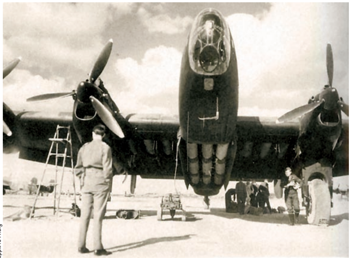
Ladowanie Halifaxa. Widać szeroko otwarte komory bombowe pełne kontenerów z bronią, amunicją i materiałami wybuchowymi
